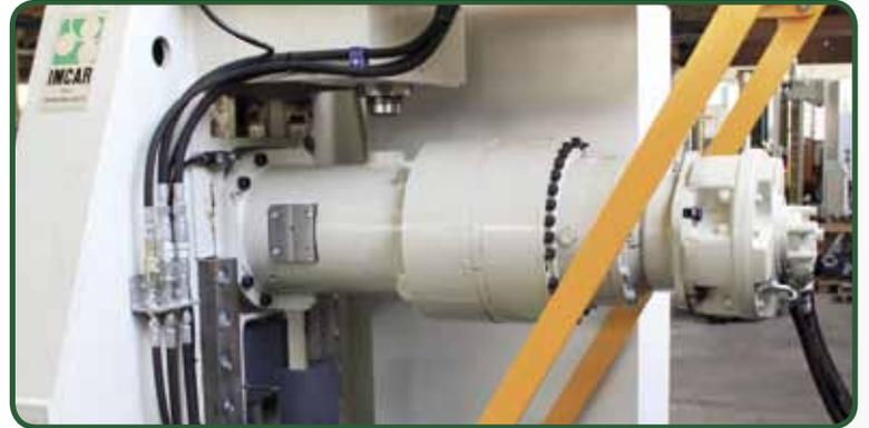
Sistema di innesto rapido per intercambiabilità del rullo superiore
