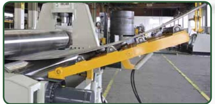
Supporto laterale / Support latéral / Soporte lateral / Lateral support / Seitenstütze / Боковая поддержка
