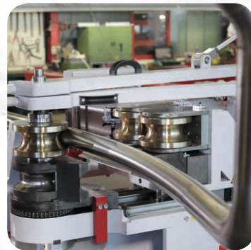
Función de conformado libre para el curvado independiente de la herramienta de radios de gran tamaño
